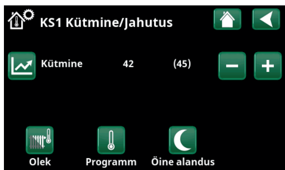
Menüü „Paigaldaja/Määratlemine/Küttering/Küttering 1“. Kütteringil ei ole ruumiandureid. Sulgudes on näidatud seadeväärtus (pealevoolutemperatuur 45^{\circ}\text{C} ), seadeväärtus vasakul on näidatud praegune pealevoolutemperatuur 42^{\circ}\text{C} .
