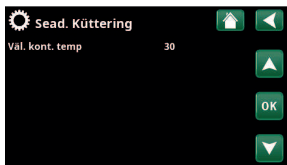
Menüü: Välise kütte või soojaveepaagi kaugjuhtimise „Paigaldaja/Seadistused/Küttering”.
